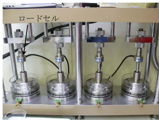
写真-3 4連載荷フレーム
