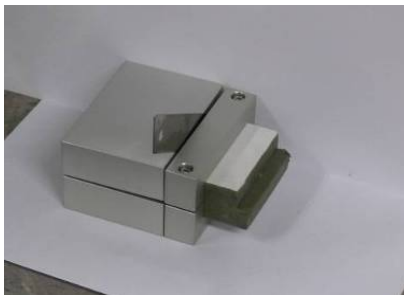
写真-8 専用器具による 供試体の切断
