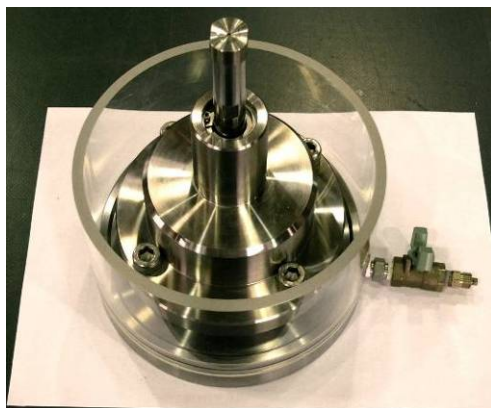
写真-2 飽和供試体作製用モールド組み立て
