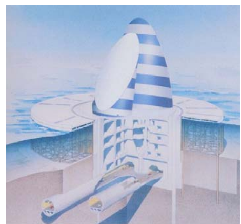
現在の川崎人工島（風の塔）：海底トンネルの排気口となっている （建設時にはシールドの発進基地として使用）
