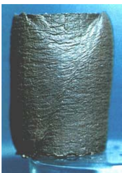
三軸圧縮試験後の粘土供試体
