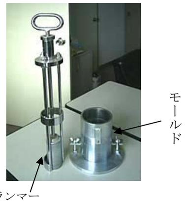
土の密詰めの度合いを表すための尺度は、間隙比、相対密度、乾燥密度などあるが、締固めの管理では乾燥密度  $\rho_d$  が用いられる。
