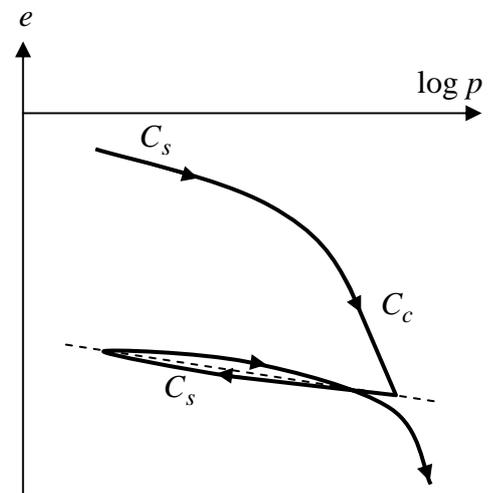
載荷初期の過圧密状態の圧縮曲線の勾配  $C_s$  は計測しづらく誤差も多い，そのため一度大きな荷重まで載荷してから除荷して，過圧密状態をわざと作り出す。そのとき，粘土は水を吸って膨潤するので，その部分の  $e \sim \log p$  曲線の勾配を膨潤指数  $C_s$  と呼び，過圧密状態での圧縮曲線の勾配と等価と考える。
