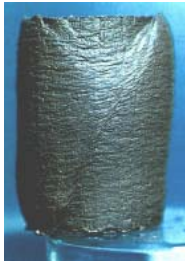
三軸圧縮試験（CU 試験）後の粘土供試体
