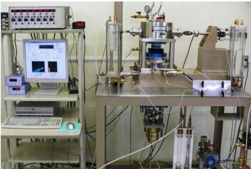
図1 単純せん断試験機
