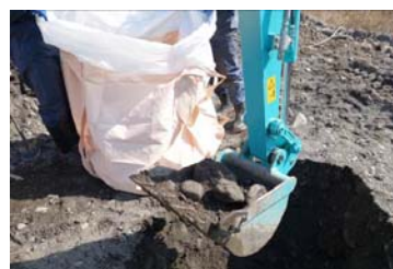
写真 1 試験試料採取状況
