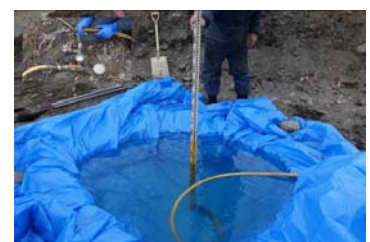
写真 2 現場密度試験/水置換状況
