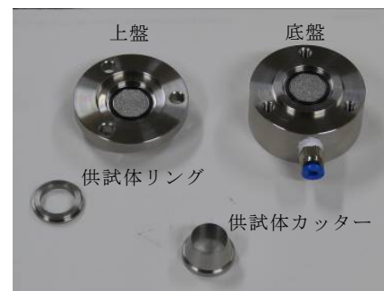
図 2 モールドの解体状況
