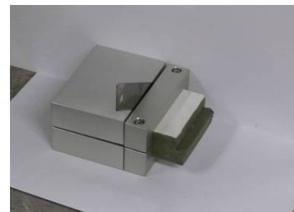
図 4 専用器具による供試体の切断
