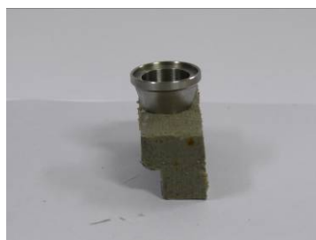
図6 ワイヤカッターに よるくり抜き
