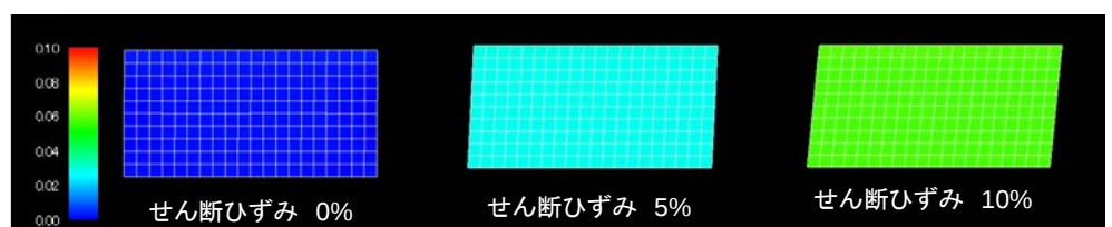
図5 端面同一高さ2節点拘束境界の解析結果 (CASE 2)
