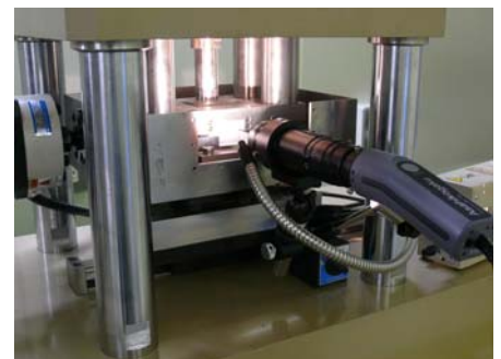
図2 マイクロスコープを用いた局 所変形帯観察システム
