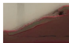
写真 3 Case2-1 被覆工の崩壊
