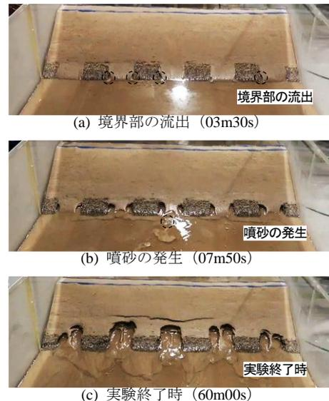
写真2 離散配置で設けた基盤排水工の効果
