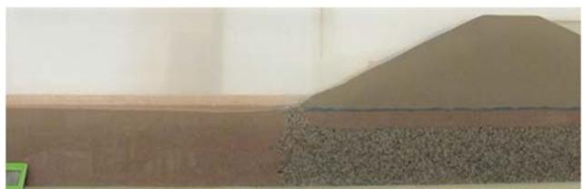
写真2 行き止まり地盤での排水工の効果(実験終了時)
