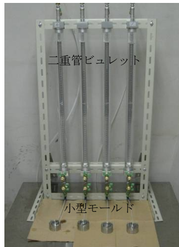
写真-3 超低透水性材料用透水試験装置
