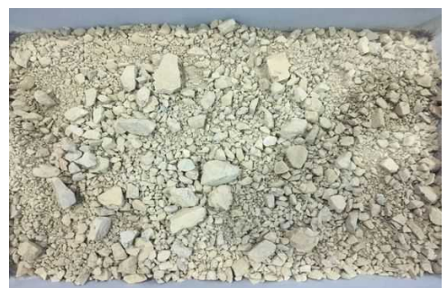
写真 2 堤体使用材料
