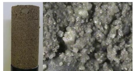
写真-1 含水比 10%で作製した供試体の全体と拡大写真
