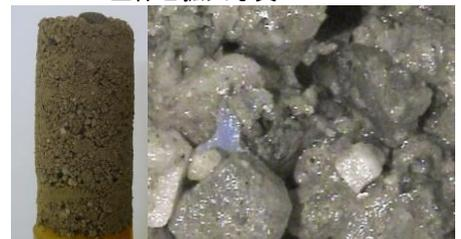
写真-2 含水比 0%で作製した供試体の全体と拡大写真
