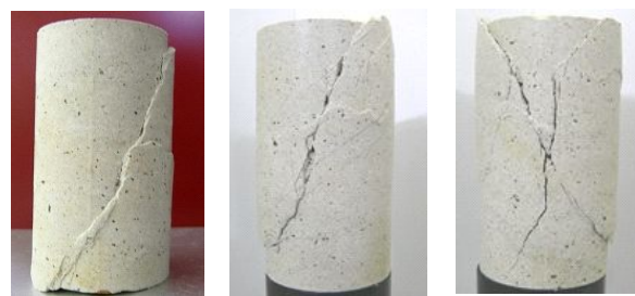
(a)拘束圧 200kPa (b)拘束圧 100kPa (c)拘束圧 100kPa 写真 1 試験後の写真(固化土 養生 14 日)
