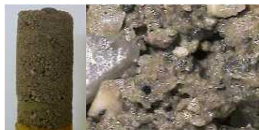
写真2 空中落下法で作製した供試体の全体(左)と75倍で拡大した写真(右)
