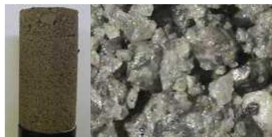
写真1 湿潤締固め法で作製した供試体の全体(左)と75倍で拡大した写真(右)
