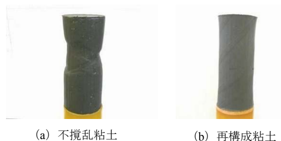
写真1 赤井粘土の三軸伸張試験後の供試体の様子
