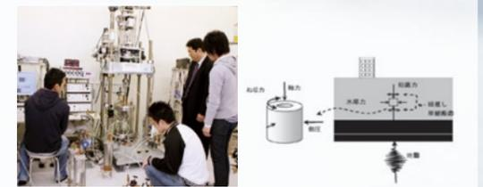
動的中空ねじりせん断試験による粘土地盤の地震時挙動の評価
