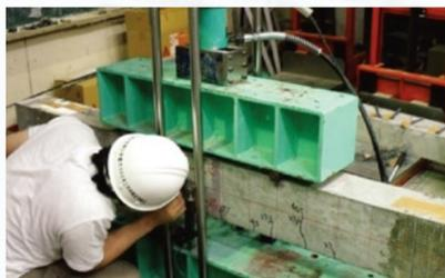
繊維材接着による補強効果の長期持続性を検証する実験の様子
