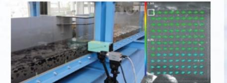
高速カメラを用いたPIV流速計測実験の様子と計測例
